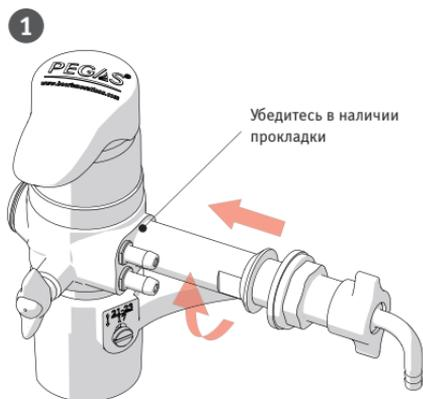
Вверните Штуцер в резьбовое отверстие корпуса (резьба 5/8") Гаечным ключом на 19.
