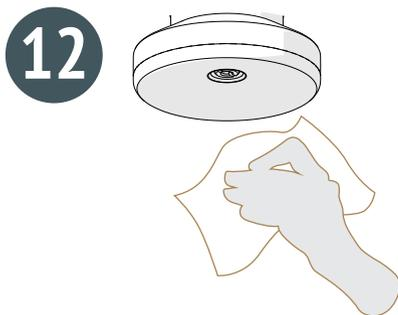
При наличии пены на прокладке наливной головки, протрите её чистой влажной безворсовой салфеткой.
