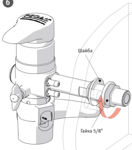
С внутренней стороны на Штуцер наденьте Шайбу и накрутите Гайку 5/8". Зафиксируйте устройство в вертикальном положении Переставными клещами и Гаечным ключом S19.
