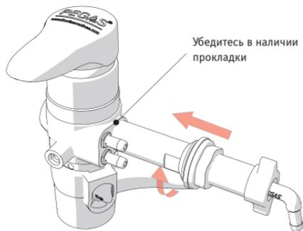
Вверните Штуцер в резьбовое отверстие корпуса (резьба 5/8") Гаечным ключом на 19.
