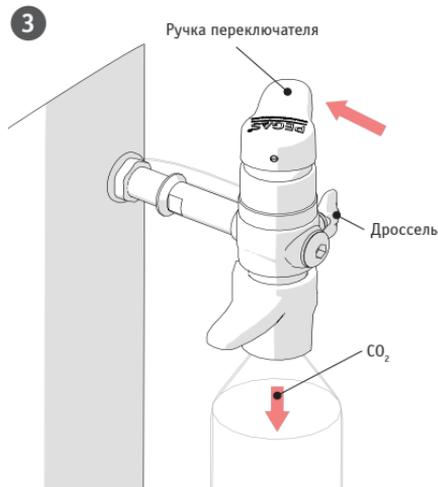
**Заполнение бутылки газом CO<sub>2</sub>**
